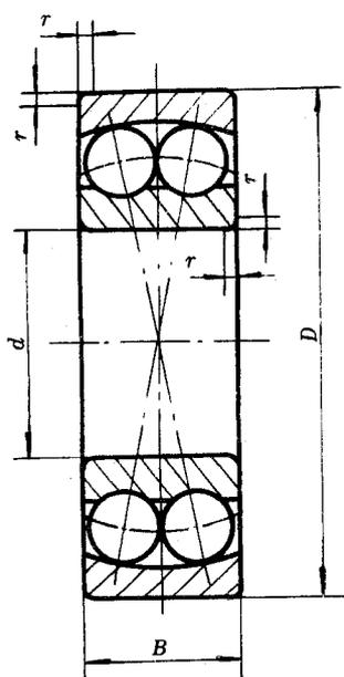
图 1 圆柱孔调心球轴承
